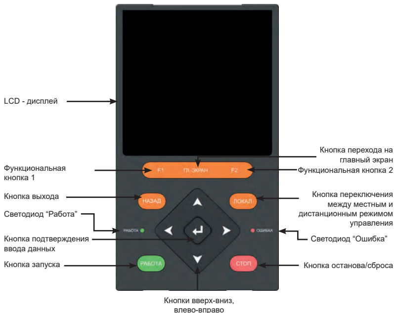
Рис. 5.1 Функции кнопок и светодиодов панели управления INPRIME
