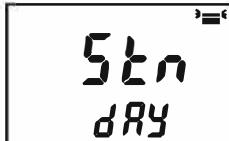
Нажмите сначала клавишу ▶ для перехода к значку субботы, потом клавишу [SET], чтобы выбрать субботу в качестве стандартного дня (значок Sat загорается) с помощью клавиш ▲ или ▼.
