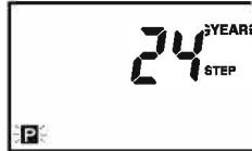
Нажмите клавишу [MODE] на 3 сек в рабочем режиме. Замигает индикатор "P". Нажмите клавишу [MODE]. Замигают индикаторы "P" и YEAR. Нажмите клавишу [SET].
