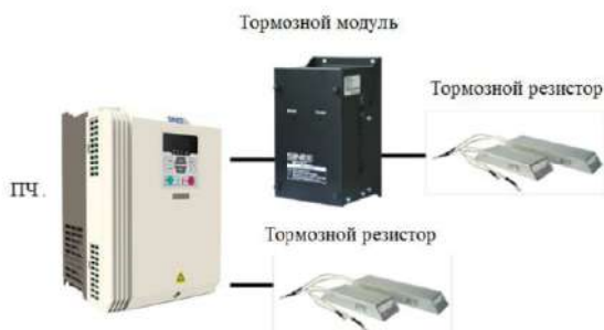
Рис. 3 Два варианта подключения тормозного резистора к преобразователю частоты (ПЧ)
