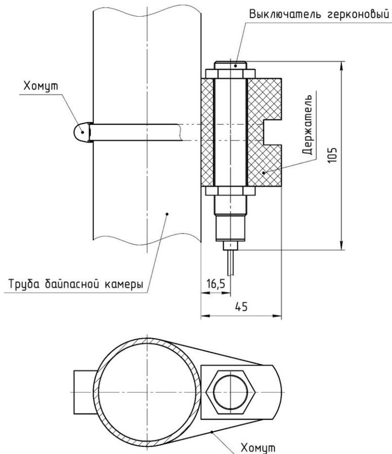
Рисунок 7.2 – Схема крепления сигнализатора уровня
