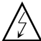
Опасное напряжение: после отключения питания подождите не менее 10 минут (для разряда конденсаторов), прежде чем снимать крышку
