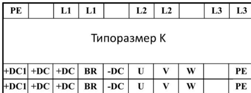
Рисунок 2-33 Силовые клеммы типоразмера K
