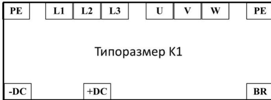
Рисунок 2-34 Силовые клеммы типоразмера K1
