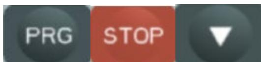
Подключите питание и отпустите кнопки – активируется параметр P10.06. Сбросьте его на 0 – функция защитного кода будет отключена.
