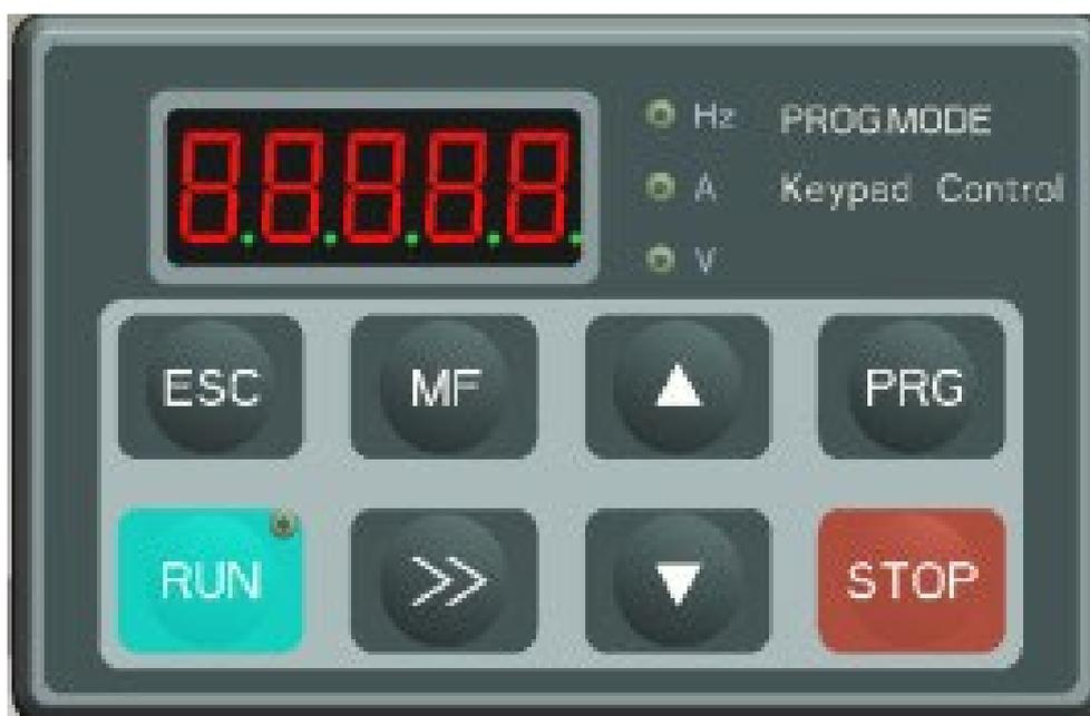
Рисунок 3-1 Светодиодная кнопочная панель
