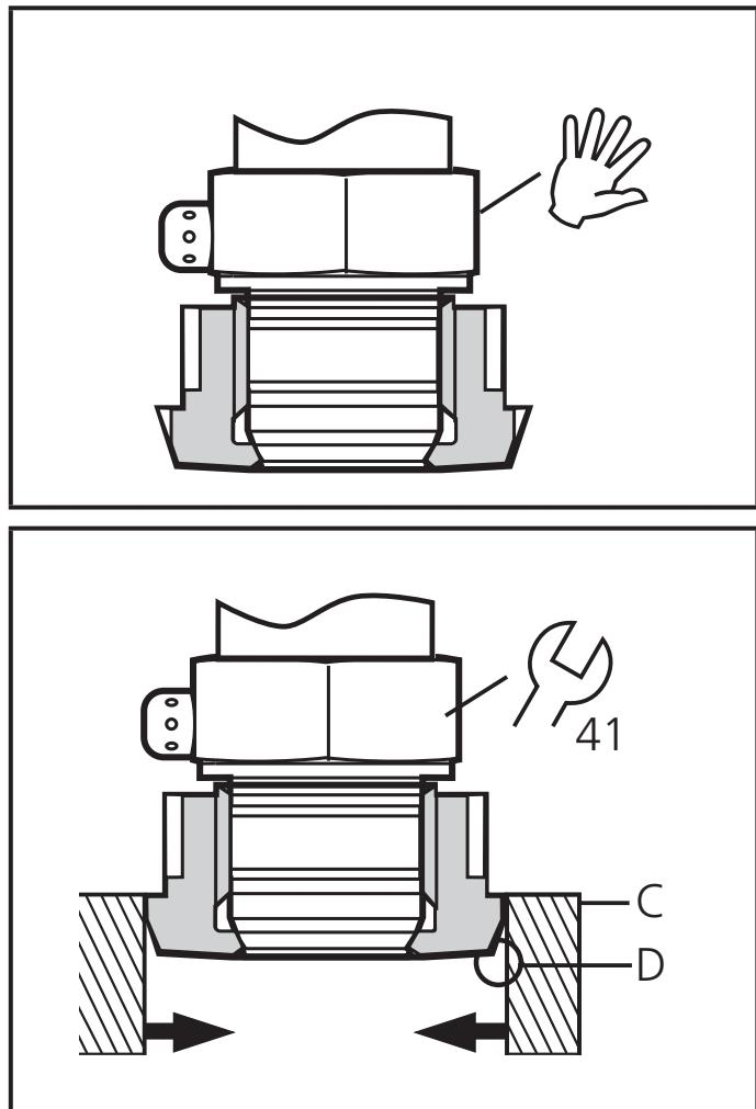
**ПРИМЕЧАНИЕ:** Гарантия долгосрочной и стабильной герметичности гигиенического металлического уплотнителя (соединение Aseptoflex) действительна только для однократной установки.
