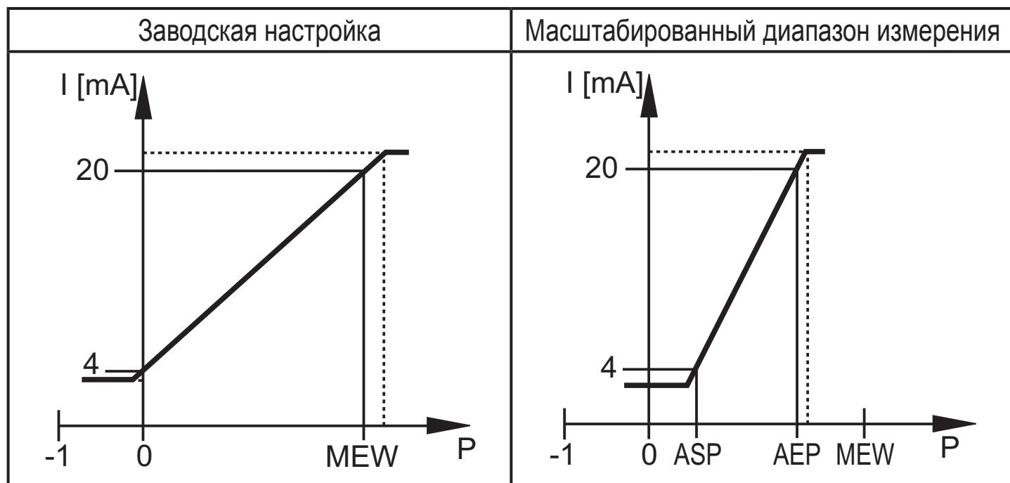
$P$  = давление в системе, MEW = предельное значение диапазона измерения
