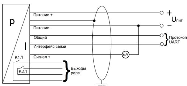
Рисунок 8. Схемы подключения с 1 или 2 релейными выходами DS 400, DS 400P, DS 401.
