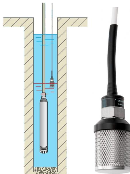
Существуют «продвинутые» решения для защиты погружного скважинного насоса от «сухого хода», которые можно применять в малых пространствах или, например, контролировать температуру около насоса.
