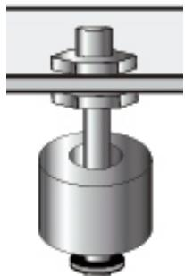
Для монтажа датчика в емкость необходимо установить в ее крышку или дно (в зависимости от контролируемого уровня) фитинг с внутренней резьбой G 1/8". Заведите датчик изнутри, проденьте кабель через отверстие и вкрутите датчик в фитинг с помощью гаечного ключа, затем снаружи емкости наденьте на резьбовой стержень уплотнительное кольцо и подтяните гайкой. Уплотнительное кольцо (1 шт.) и гайка (1 шт.) входят в комплект поставки.
