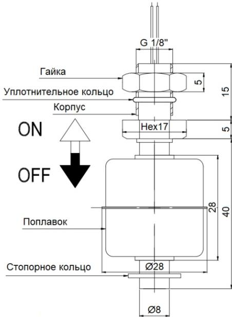
Размеры указаны в мм, кроме размера трубной резьбы.
