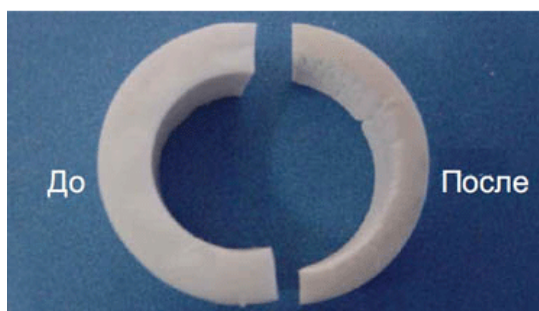
Испытания полипропилена на стойкость к хлору
