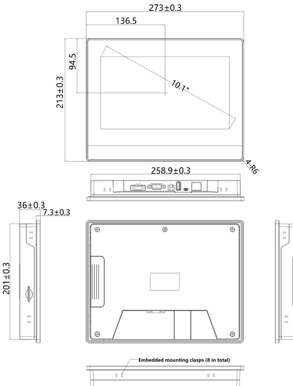
Размер окна для встраиваемого монтажа 260 мм x 202 мм
