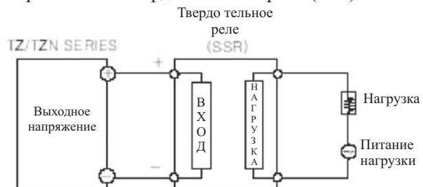
\* SSR должно подбираться в соответствии с мощностью нагрузки, иначе может возникнуть короткое замыкание.
