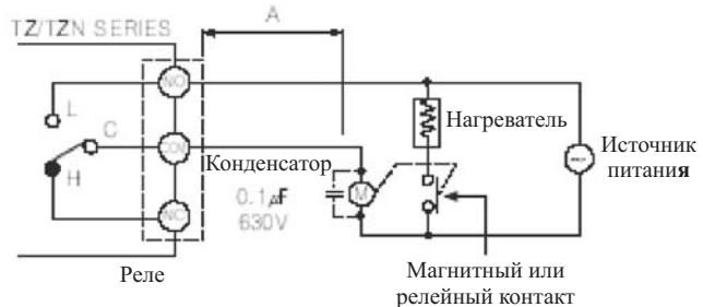
Источник питания реле должен быть расположен как можно дальше от TZ/TZN контроллера. Если длина провода А недостаточна, то токи намагничивания, возникающие в обмотках катушки могут вызвать сбои в работе прибора. Если недостаточна длина провода , подсоедините майларный конденсатор 0,1мФ (104 630В) через катушку реле "M" для защиты от намагничивания.
