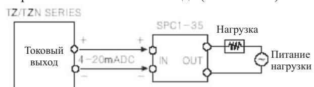
\* Важно, чтобы выходному токовому сигналу соответствовал токовый вход.
