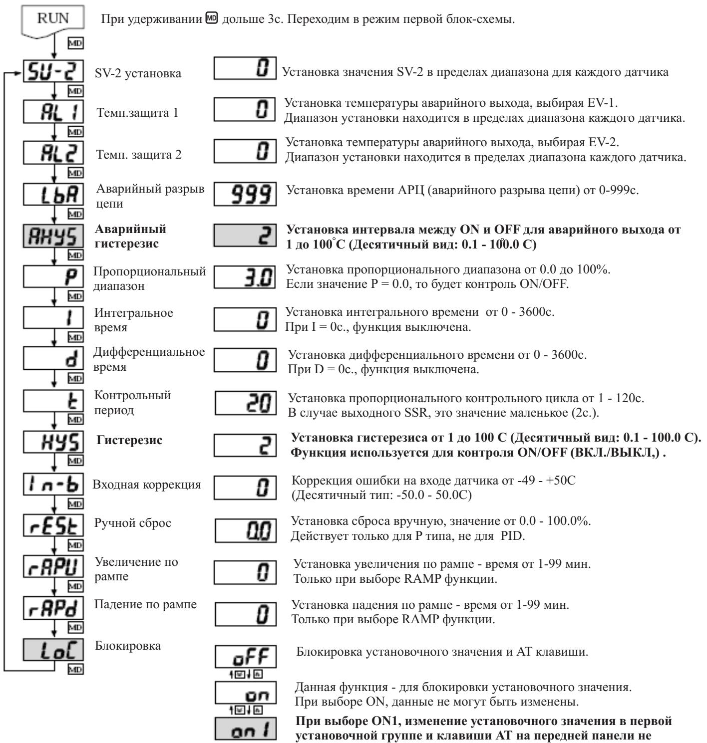
\* При нажатии клавиши **█** начинает мигать разряд, мигающий разряд смещается нажатием клавиш **█ □**, а значение изменяется клавишами **▼ ▲**.
