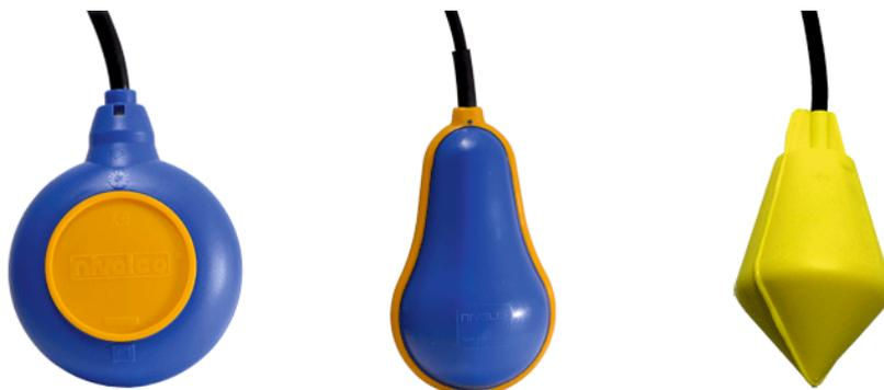
Монтаж данных поплавковых выключателей воды осуществляется следующим образом: груз, находящийся на кабеле, опускается на необходимую высоту, которая является уровнем срабатывания (см. рис. справа). При достижении заданного уровня поплавок поднимается вверх относительно груза, при этом металлический шарик нажимает на контакты и тем самым изменяет состояние выходной цепи.
