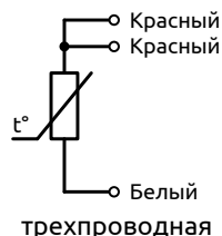
Рисунок 2 – Схемы соединения внутренних проводов термопреобразователя TRE.C41
