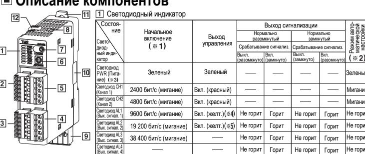
\* 1: При начальном включении светодиод будет мигать в течение 5 секунд (с частотой 1 раз/с).
