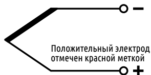
Рисунок 2 – Схемы соединения внутренних проводов преобразователя термоэлектрического TCE.C02
