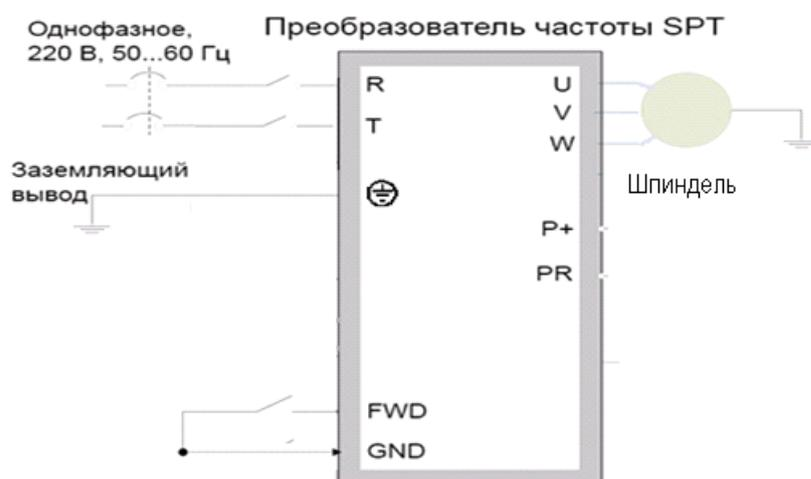
Преобразователь подключить к сети клеммы R и T через автоматический выключатель 10А.
