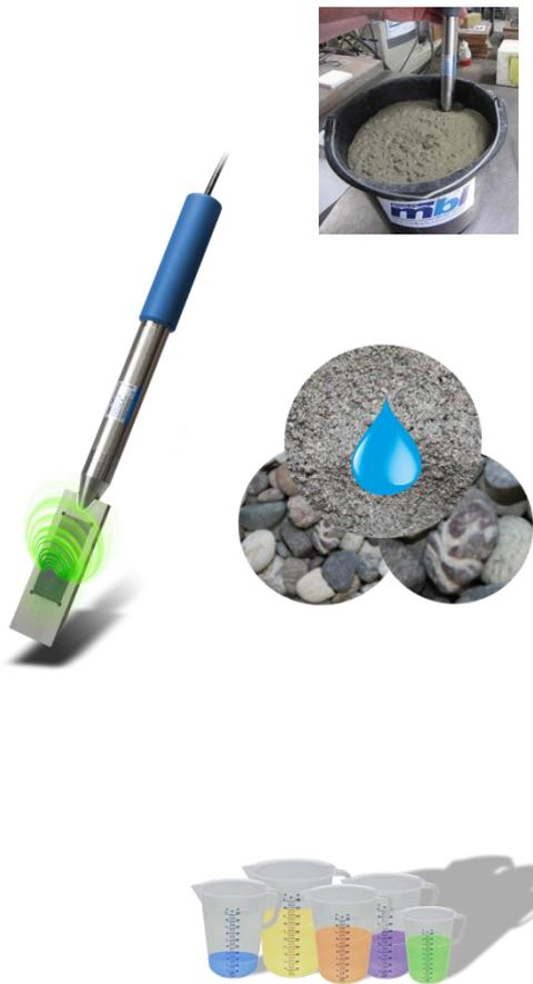
**1. Das freie Wasser** in der Betonmischung welches für den w/z-Wert angerechnet wird. Dieses Wasser ist der eigentlich gesuchte Zielwert bei der Anwendung von SONO-WZ.
