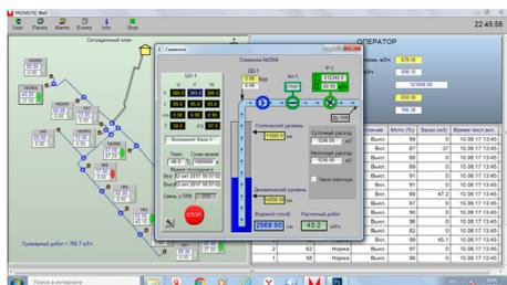
Рис 2. Интерфейс мониторинга и управления скважиной
