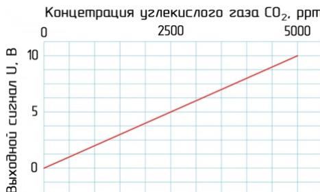
График преобразования уровня концентрации CO<sub>2</sub> в аналоговый сигнал
