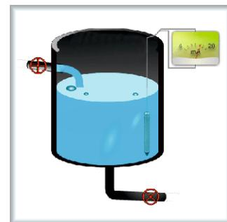
Гидростатические уровнемеры предназначены для непрерывного контроля уровня жидкости. Это надежные уровнемеры, работающие в разных условиях.
