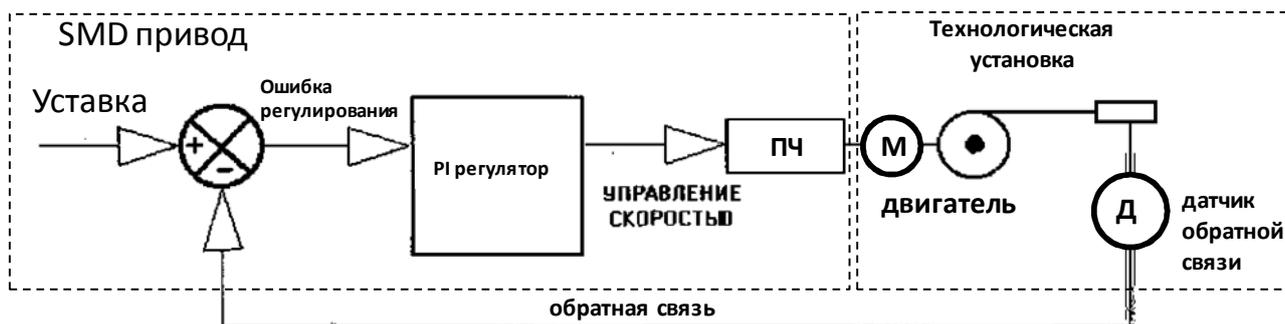
К типичным примерам применения, которые используют PI-регулирование, относятся те технологические процессы, в которых регулируется давление, поток, скорость, напряжение и температура.
