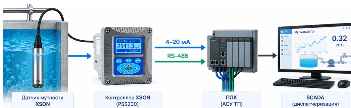
Схема передачи данных от датчика мутности в АСУ ТП и SCADA
