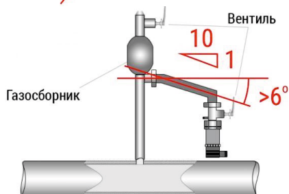
Рисунок 8 – Способы монтажа преобразователя для измерения давления жидкости
