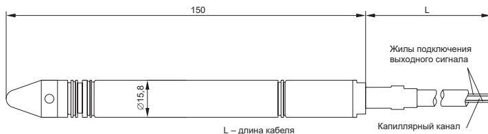
и) общий вид компактного преобразователя погружного, предназначенного для измерения давления водяного столба
