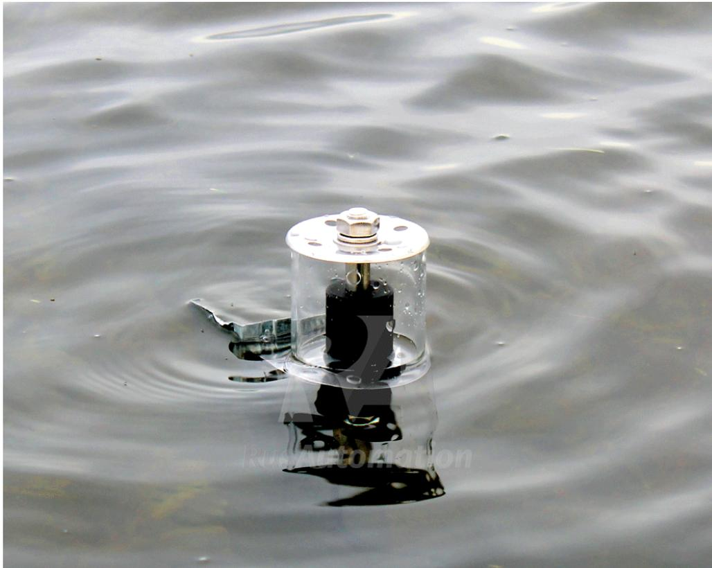
Защищенная конструкция позволяет установить датчик подтопления водой даже на покрытом травой участке берега, тем самым обеспечить скрытность его монтажа. Применение магнитоуправляемого герметизированного контакта (геркона) позволяет обеспечить надежность и долговечность работы даже в условиях повышенной влажности и полного затопления датчика.
