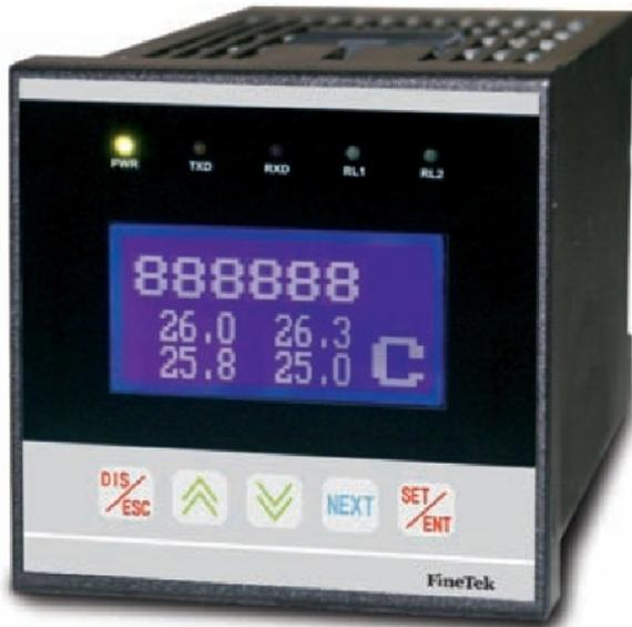
Мультифункциональный индикатор скорости и температуры разработан для определения и контроля температуры подшипника и скорости барабана транспортной ленты или подъемных механизмов. Он включает аварийный сигнал или подает сигнал для остановки системы при отклонении в работе. Пользователи будут иметь больше информации про условия работы оборудования, процент сбоев.
