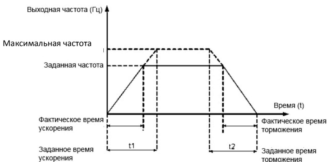
Преобразователь частоты INTEK серии AX300 обеспечивает наличие 3 групп параметров, определяющих значения времени ускорения/торможения. Пользователь может совершать переключение между значениями с помощью дискретных входов. См. параметры P8.00 – P8.10.
