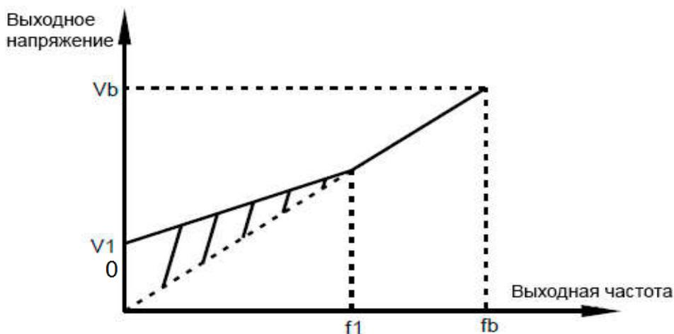
На рисунке: V0 – Буст (форсировка напряжения при нулевой частоте) (P4.01); Vb - номинальное напряжение (P2.02); f1 - точка перегиба кривой V/f (P4.02); fb - номинальная частота двигателя (P2.04).
