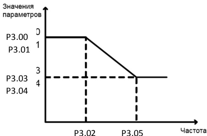
Динамические характеристики контура скорости в режиме векторного управления могут быть настроены с помощью установки значений пропорционального коэффициента усиления и времени интегрирования регулятора скорости. Для достижения более быстрого отклика системы, необходимо увеличить значение пропорционального коэффициента усиления и уменьшить время интегрирования. Стоит учитывать, что неправильная настройка может привести к колебательным процессам в системе и её неустойчивости.
