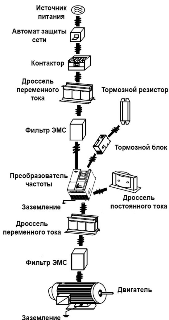
Подключение преобразователя частоты (использование некоторых элементов схемы – не обязательно)
