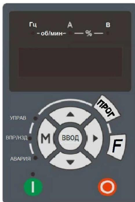
Внешний вид панелей управления преобразователей частоты АХ300
