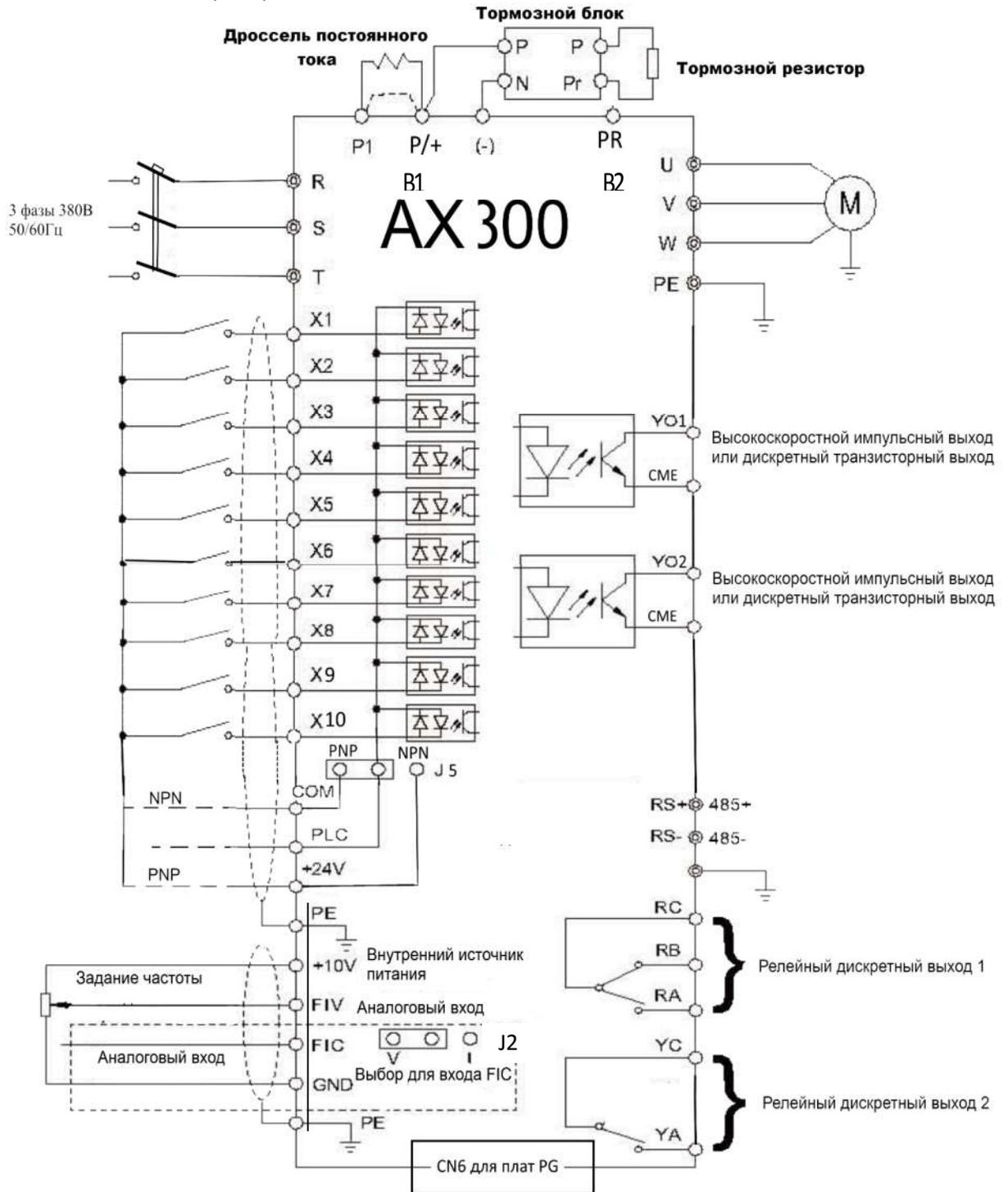
При отсутствии тормозного модуля тормозной резистор подключается к клеммам P/+ и PR (B1 и B2).
