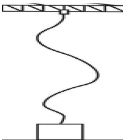
вертикального движения функция контроля слабины может использоваться как для предотвращения рывка при начале подъема лежащего груза и связанной с этим перегрузки по току, так и для ускорения выборки этой слабины. При этом может использоваться вращение привода с повышенной скоростью, выше номинальной частоты вращения двигателя.
