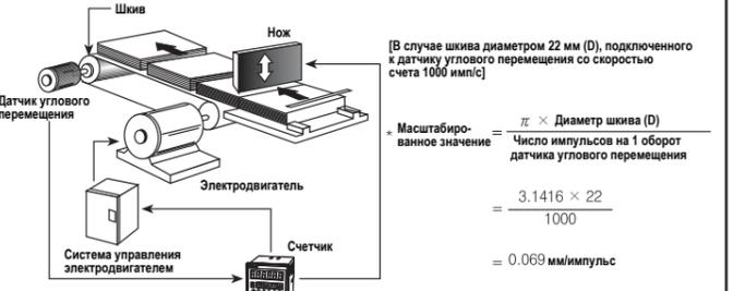
Масштабированное значение =  $\frac{\pi \times \text{Диаметр шкива (D)}}{\text{Число импульсов на 1 оборот датчика углового перемещения}}$
