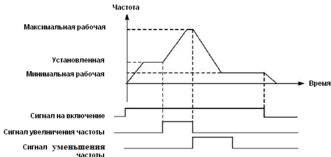
Внимание: по умолчанию изменения частоты, выполненные с помощью команд «UP» и «DOWN» не будут сохранены в памяти перед выключением ПЧ, и при последующем запуске частота будет установлена в соответствии со значением параметра Pb00. (См. также PE35)
