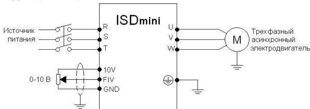
Пояснение: изменение частоты происходит при изменении напряжения, поданного с внешнего потенциометра (10 кОм) на вход AVI (для моделей до 37 кВт) или на вход FIV (для моделей от 45 кВт).
