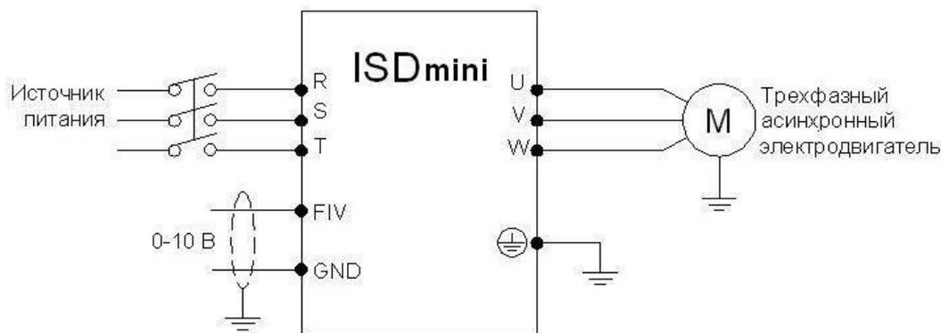
Аналоговое напряжение 0-10В можно сформировать внешним потенциометром 0-10кОм. Изменение частоты происходит при изменении напряжения от 0 до 10 В между клеммами AVI и GND (для моделей до 37 кВт) или клеммами FIV и GND (для моделей от 45 кВт и выше):
