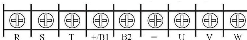
Момент затяжки винтов на силовых клеммах преобразователя 1,4 Н·м.
