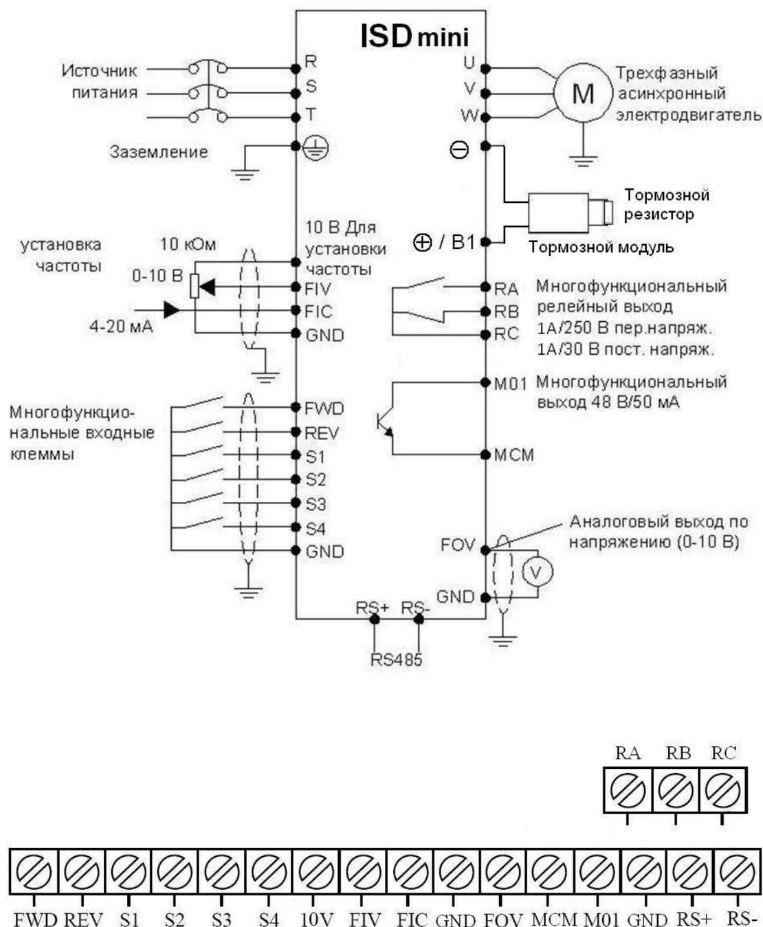
Момент затяжки винтов на клеммах - 0.2 Нм.
