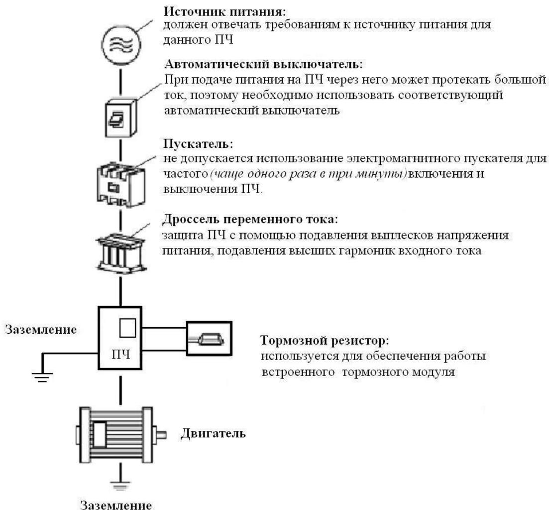
**⚠ Подключение проводов питания преобразователя следует производить только к клеммам R, S, T (L1, L2, L3).**
