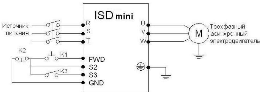
(2) Настройка параметра PF33 определяющего направления вращения
