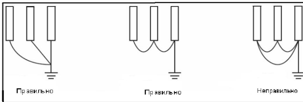
(8) Силовой кабель и управляющие провода должны быть размещены отдельно; параллельные провода должны быть разнесены не менее, чем на 100 мм, пересечение проводов должно происходить под прямым углом. Запрещается размещать управляющие провода и силовой кабель в одном кожухе во избежание помех.
