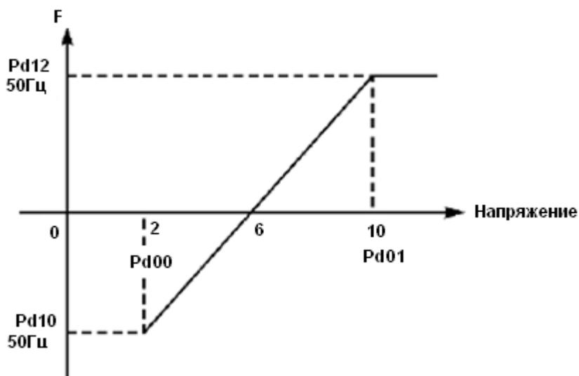
Примечание:  $Pd00=2$ , минимальное входное напряжение на входе AVI (U): 2 В (сигнал с напряжением ниже 2 В считается равным нулю);
