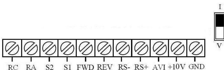
Момент затяжки винтов на клеммах - 0.2 Нм.
