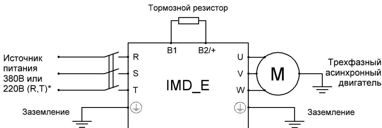
Электрическая схема подключения тормозного резистора
