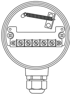
сильно налипающий материал (положение пружины 1)
