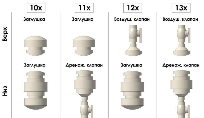
Рисунок 2.1 – Конфигурации байпасных камер
