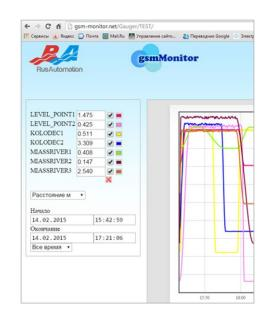
Передача данных с устройств и управление ими может осуществляться в виде простых SMS-команд, а также путем пакетной передачи данных по стандарту GPRS.
