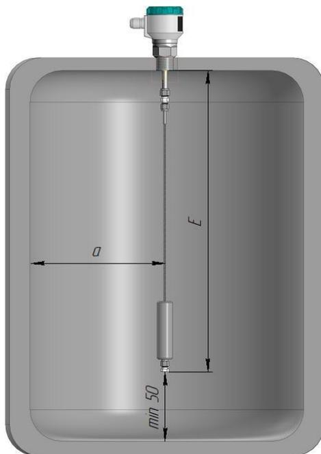
Рисунок 9.1 – Схема установки датчика GRLM – 70N-... на емкость
