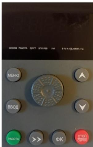
Рис. 4.1- Панель управления преобразователем частоты.
