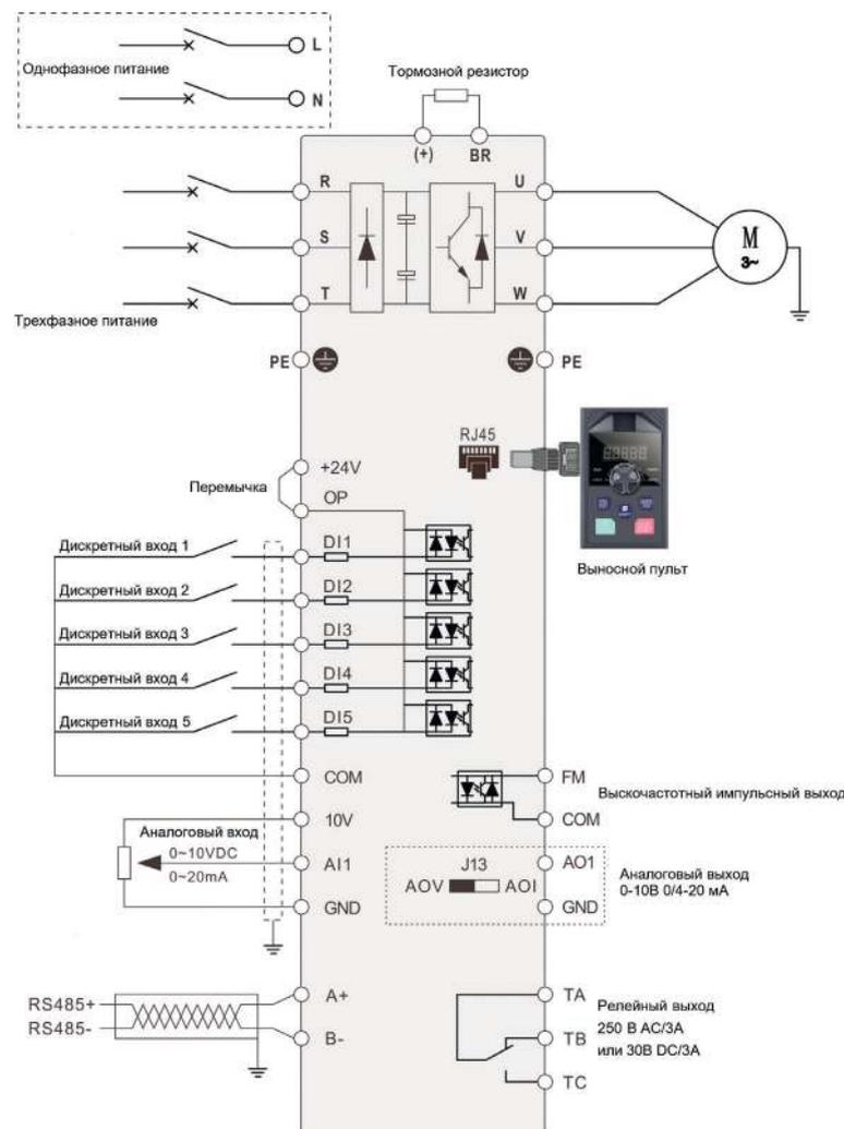
Примечание: Для подключения преобразователя частоты с однофазным питанием 220 В используются клеммы L и N.
