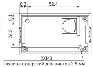
Установка винтов: чертёж с размерами прорези в панели
