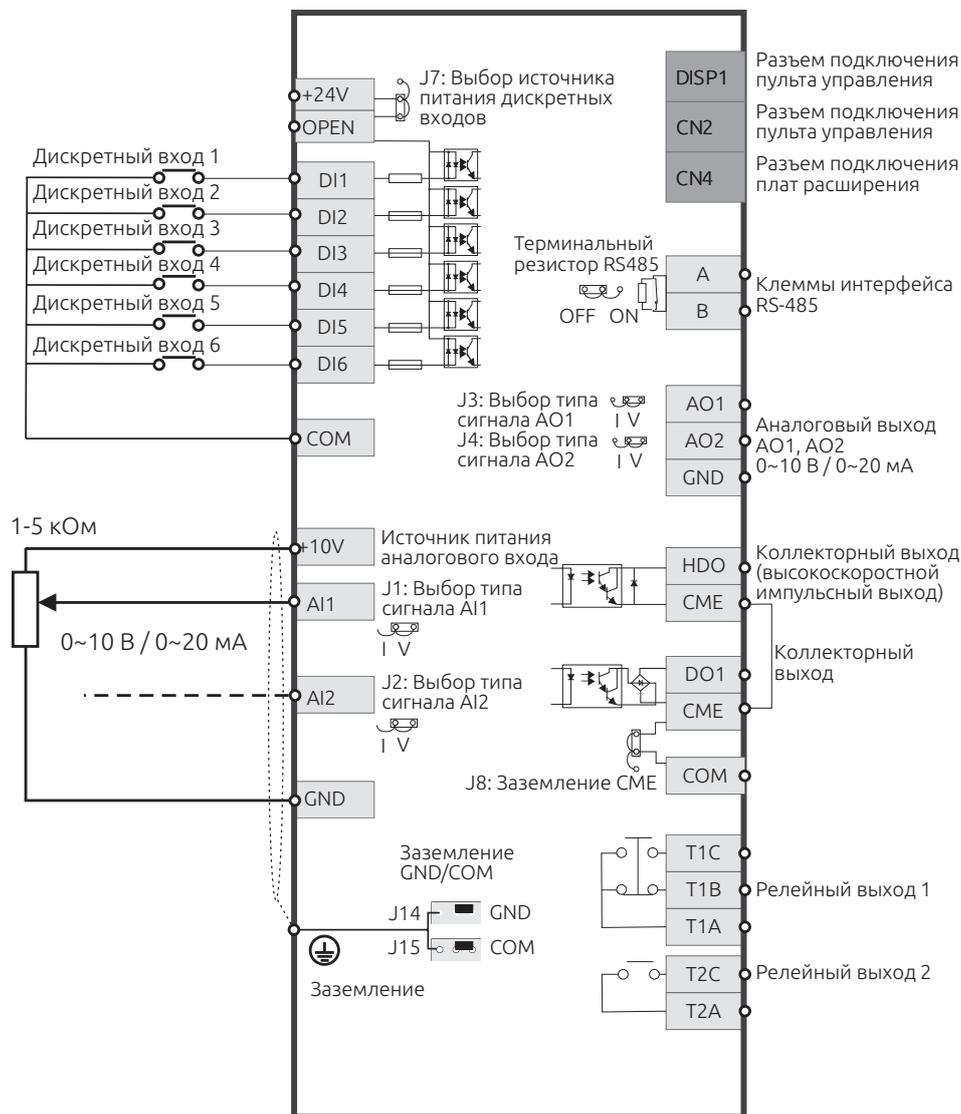
**Примечание:** на мощностях 0.75–4 кВт клеммы DI6, AO2, DO1 и CME отсутствуют.
