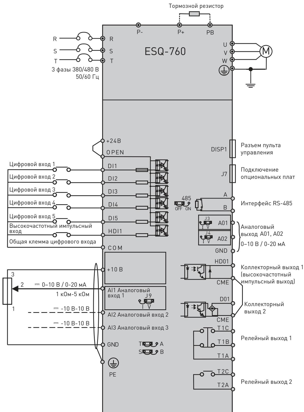
**Примечание:** тормозной прерыватель встроен в моделях до 22 кВт включительно (режим G).
