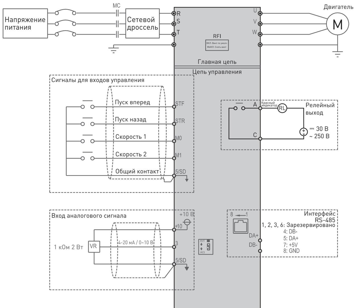
**Примечание:** одновременно использовать выносной пульт управления и интерфейс связи RS-485 для управления частотным преобразователем нельзя.
