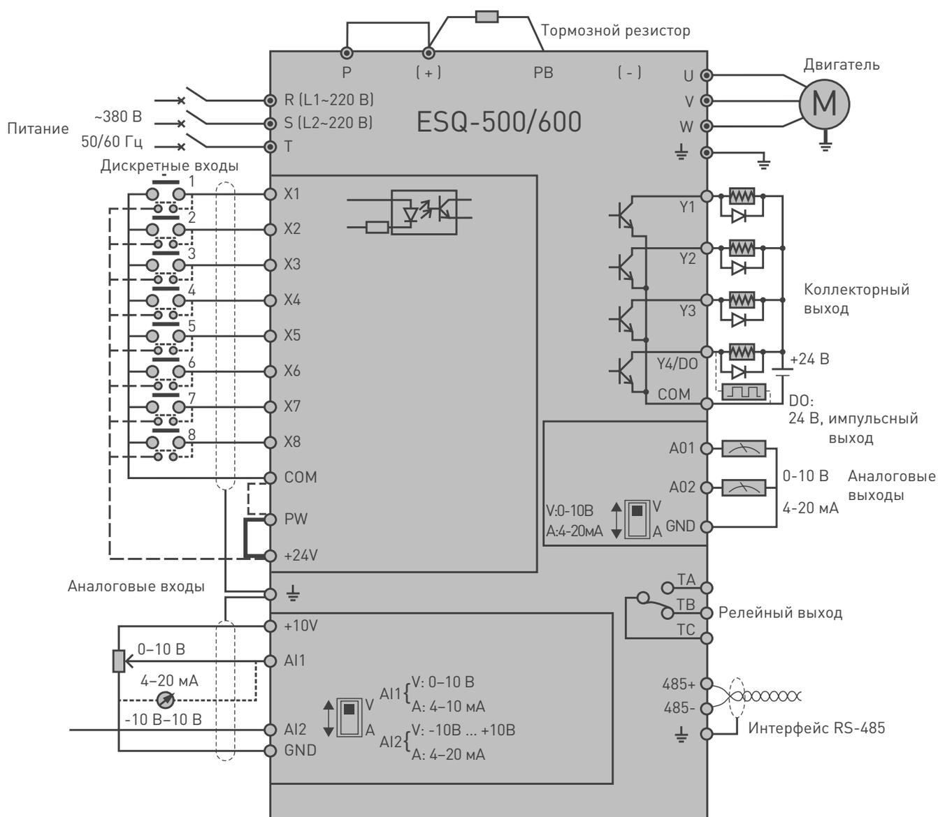
**Примечание:** тормозной прерыватель встроен в моделях до 15 кВт включительно (режим G). Тормозной прерыватель подключается к клеммам (+) и (-). Свыше 15 кВт для подключения тормозного резистора требуется внешний тормозной прерыватель или модель с индексом «BU». Дроссель звена постоянного тока встроен в моделях свыше 90 кВт (включительно).
