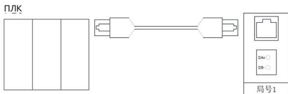
3. Канал связи между задающей положение контроллером (в качестве примера взят ПЛК) и несколькими инверторами.
