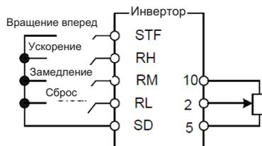
2. С дистанционной настройкой выходная частота инвертора равна заданию частоты от клемм RH/RM + внешняя настройка частоты, кроме многоскоростной/настройка частоты с пульта PU)
