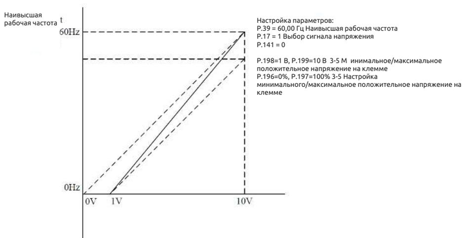
Пример 7: Это пример применения отрицательной настройки наклона зависимости. В промышленности часто используются датчики давления, температуры и расхода. Некоторые из таких датчиков выдают сигнал 10 В при высоко напряжении или высоком расходе. Этот сигнал действует как задание для инвертора для замедления или останова двигателя. Конфигурация, представленная в Примере 8, может хорошо работать в системах такого типа.
