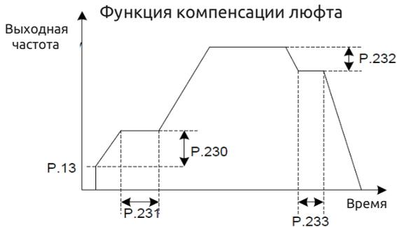
**Примечание: Настройка компенсации люфта только удлиняет время ускорения/замедления в случае прерывания работы с неизменной скоростью.**
