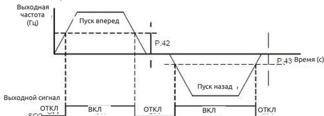
**Примечание:** В этом разделе SU, FU - это названия функций для “клеммы универсального цифрового выхода” SO1, SO2. Смотрите описания параметров 03-10 ~ 03-13. Соответствующая электропроводка описана в разделе 3.5.
