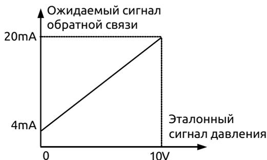
**Рис. 7-38 Эталонный и ожидаемый сигнал обратной связи**
