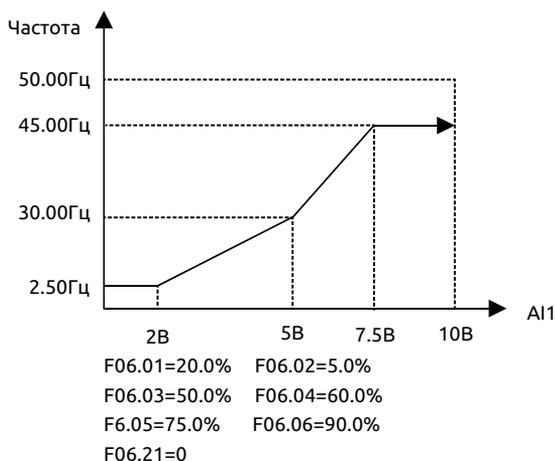
**Рис. 7-11 Выбор настройки частоты кривой 1 с использованием входа A11**
