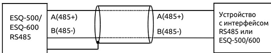
Рис. 3-18 Подключение к оконечному устройству связи
