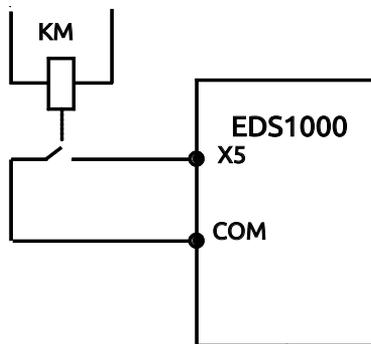
**Рис. 7-15** Нормально разомкнутый канал передачи сигнала об ошибке периферийных устройств
