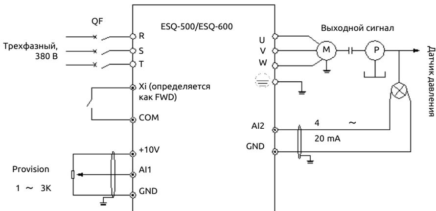
**Рис. 7-36** Схема системы управления со встроенным ПИД-регулятором
