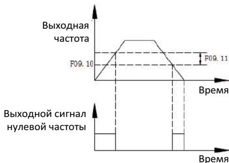
**Рис. 7-25 Обнаружение сигнала нулевой частоты**
