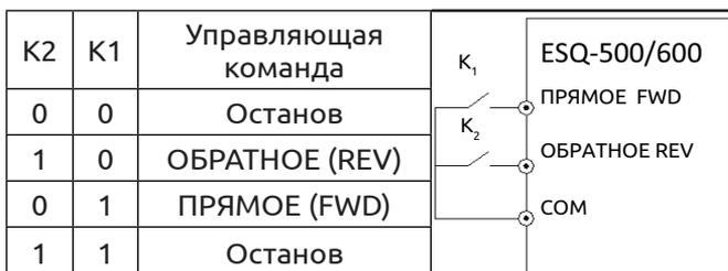
**Рис. 7-16 Режим двухпроводного управления 1**
