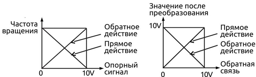
**Рис. 7-40 Характеристики регулирования в замкнутом контуре**
