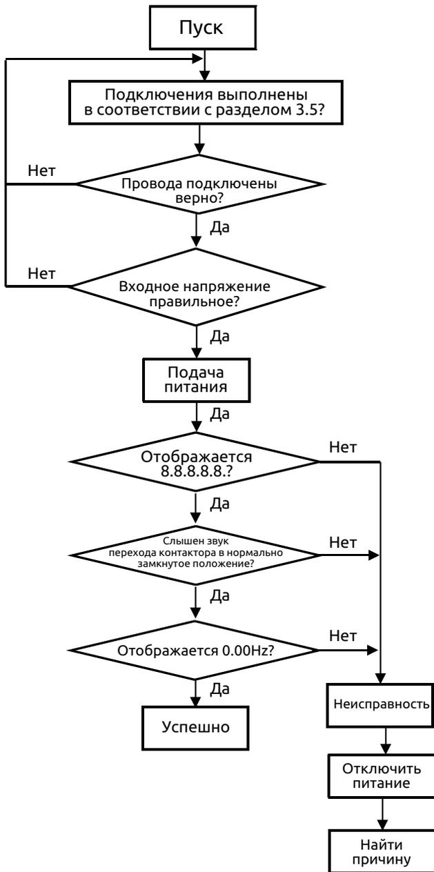
Рис. 5-12 Порядок действий при первом включении питания
