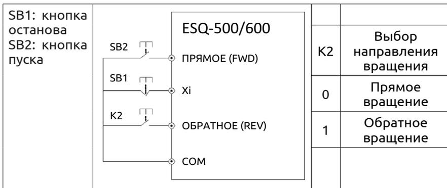
**Рис. 7-20 Режим трехпроводного управления 2**
