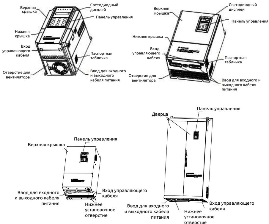
Рис. 2-3 Конструкция преобразователя частоты
