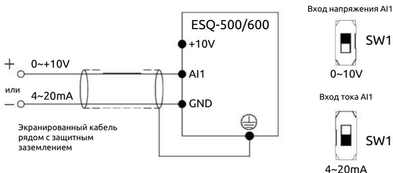
Рис. 3-11 Схема подключения входа AI1
