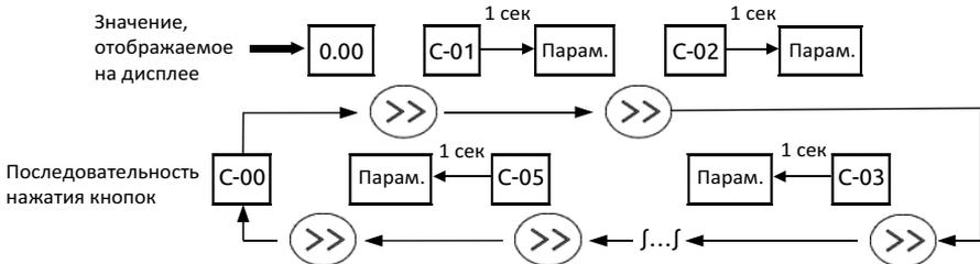
Рис. 5-7 Пример отображения параметров режима состояния
