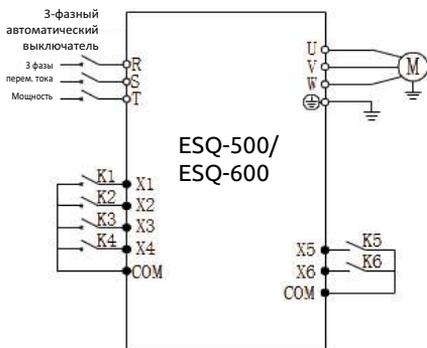
**Рис. 7-14** Схема электрических соединений при многоступенчатом регулировании скорости
