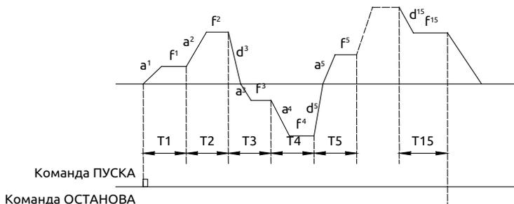
Рис. 7-31 Останов ПЛК после завершения одного цикла
