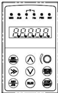
Рис. а Подача питания, отображение 8.8.8.8.8.
