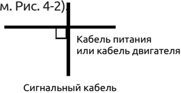
**Рис. 4-2 Требования к электрическим подключениям**
