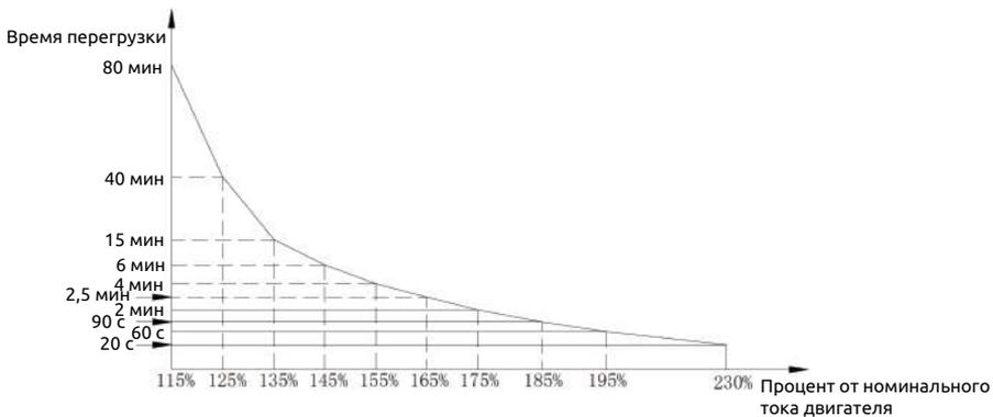
**Рис. 7-46** Защиты с помощью электронного теплового реле
