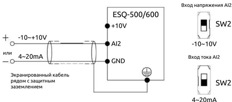
Рис. 3-12 Схема подключения входа AI2
