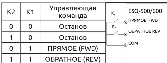
Рис. 7-17 Режим двухпроводного управления 2
