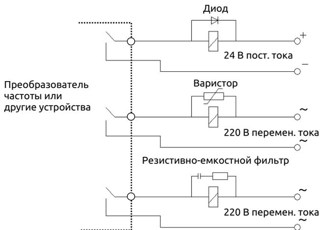
Рис. 4-3 Требования к установке электронных устройств с электромагнитным переключателем
