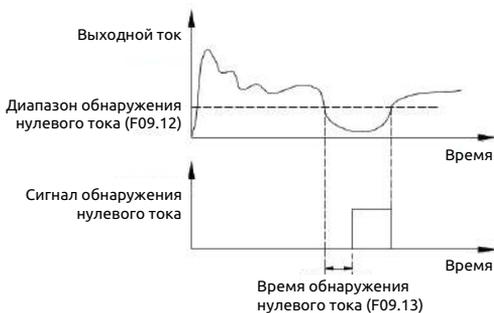
**Рис. 7-26 Схема обнаружения нулевого тока**
