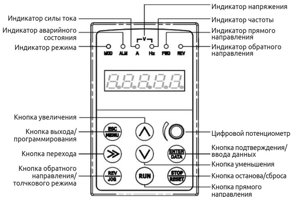
Рис. 5-2 Устройство панели управления
