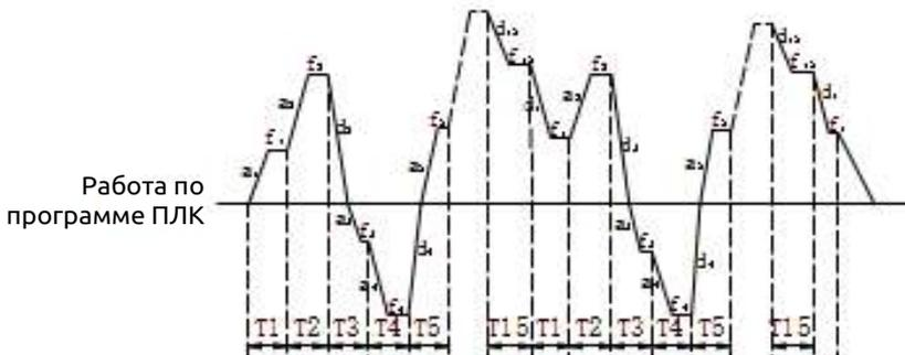
**Рис. 7-33 Режим непрерывной работы по программе ПЛК**
