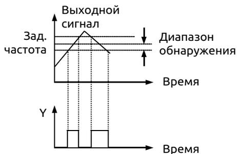
Рис. 7-23 Схема формирования выходного сигнала достижения заданной частоты
