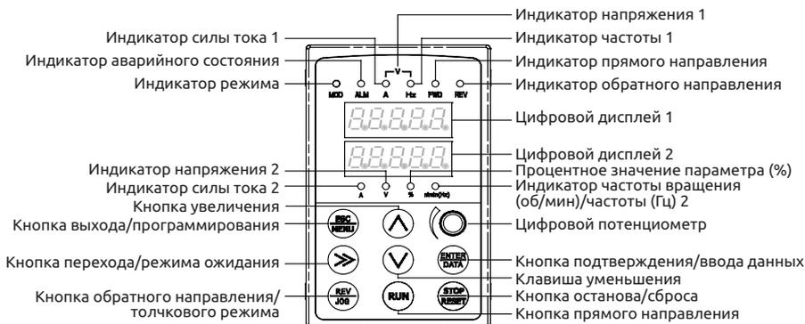
Рис. С-1. Устройство панели управления EN-LED4-D
