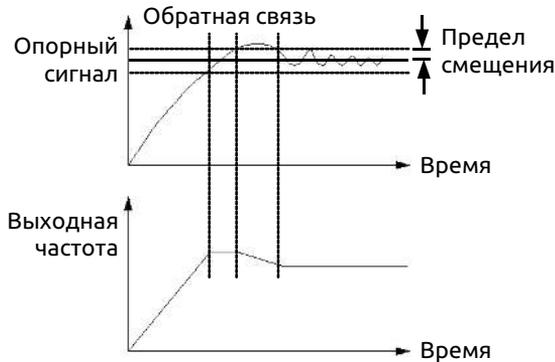
Рис. 7-39 Предел отклонения ПИД-регулирования
