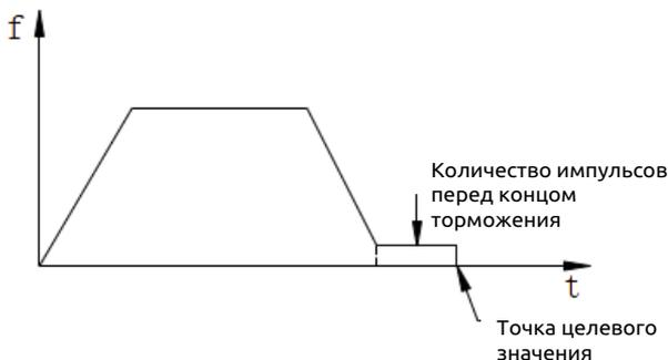
**Рисунок 7-44. Остаточные импульсы после завершения торможения при позиционировании**
