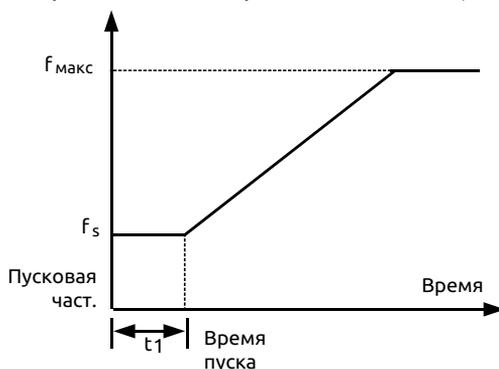
**Рис. 7-3 Стартовая частота и время удержания стартовой частоты**
