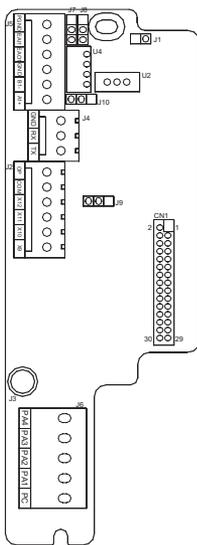
Рис. Н-1. Чертеж платы EN-PLC1
