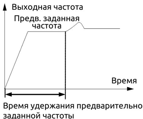
**Рис. 7-42 Управление по замкнутому контуру с предварительно заданной частотой**
