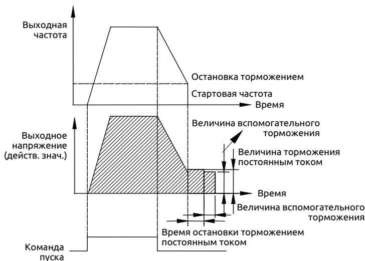
**Рис. 7-5 Торможение до останова + торможение постоянным током**
