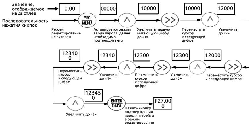
Рис. 5-11 Ввод пароля для управления кодами функций
