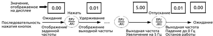
Рис. 5-10 Пример работы в толчковом режиме
