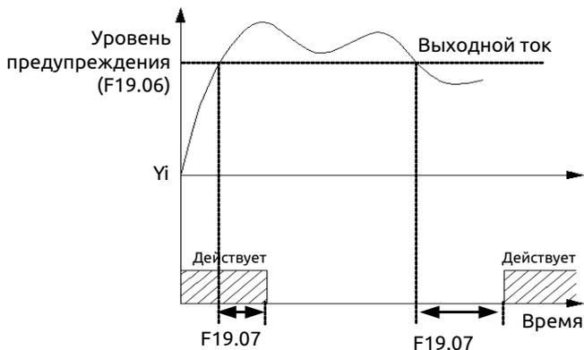
Рис. 7-47 Сигнал тревоги о перегрузке
