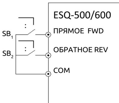
Рис. 7-18 Режим двухпроводного управления 3
