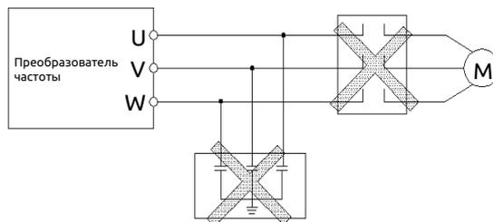
Рис. 3-6 Запрет на использование контактора и фильтрующего конденсатора
