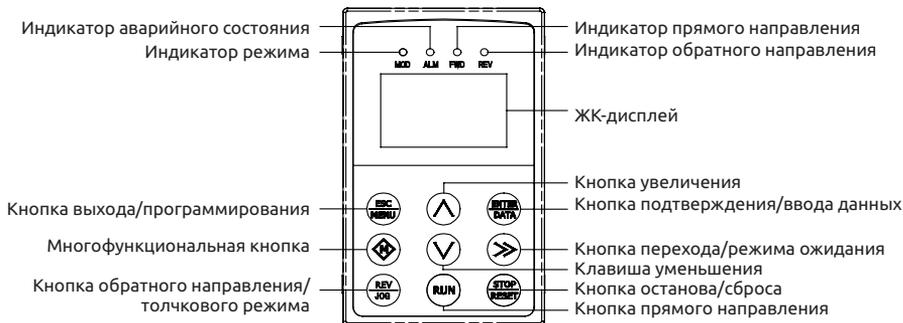
Рис. С-2. Устройство панели управления (EN-LCD1, EN-LCD2)
