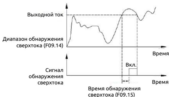
**Рис. 7-27** Схема обнаружения сверхтока на выходе
