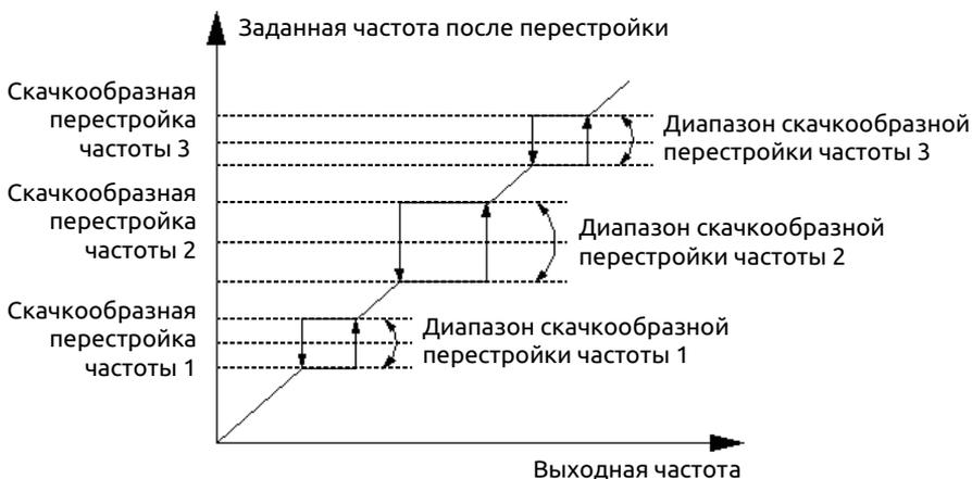
**Рис. 7-9 Скачкообразная перестройка частоты и диапазоны перестройки**
