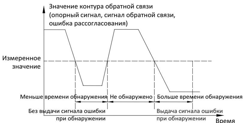
**Рис. 7-50** Временная диаграмма для обнаружения сигналов в контуре обратной связи
