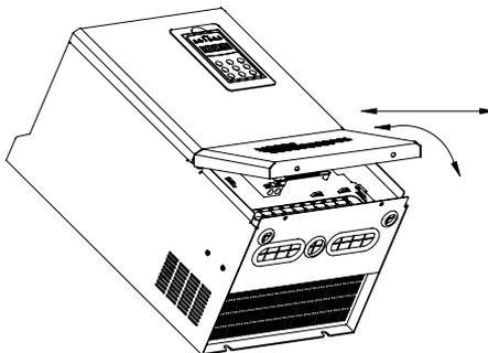
**Рис. 3-5 Снятие и установка
