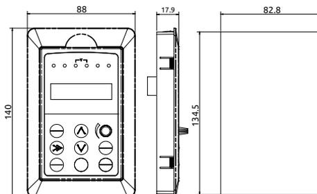
Рис. 2-7 Размер отверстия под панель управления
