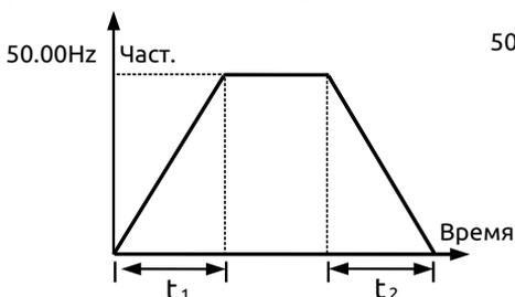
Рис. 7-1 Линейный профиль разгона/торможения
