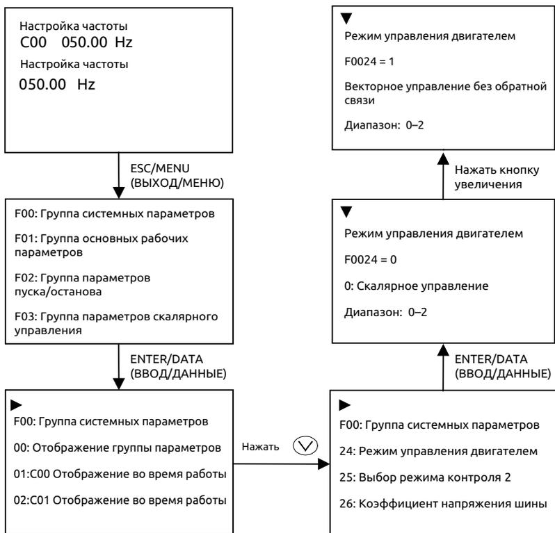
**Рис. С-6. Пример изменения функционального параметра**
