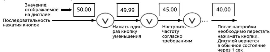
Рис. 5-9 Пример настройки заданной частоты
