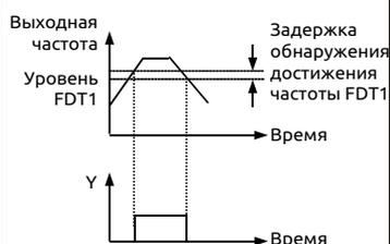
**Рис. 7-24 Схема обнаружения значения частоты**
