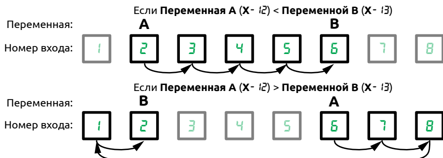
Рисунок 20 - Принцип выборки диапазона значений для вычисления среднего арифметического
