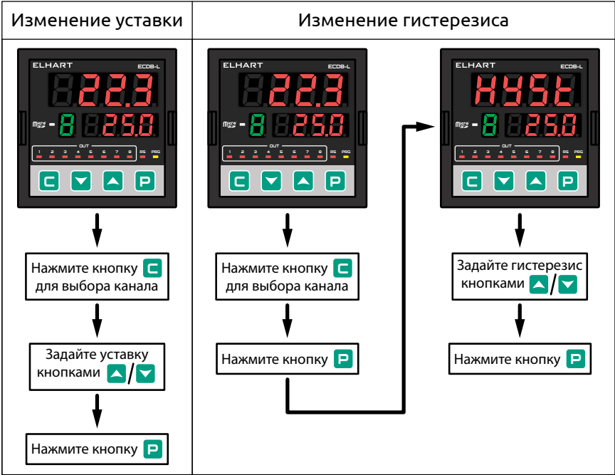
Рисунок 30 - Изменение уставки и гистерезиса
