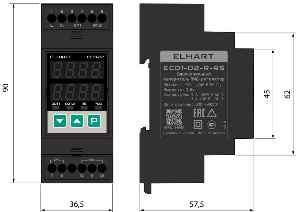
Рисунок 1 - Внешний вид и основные размеры прибора
