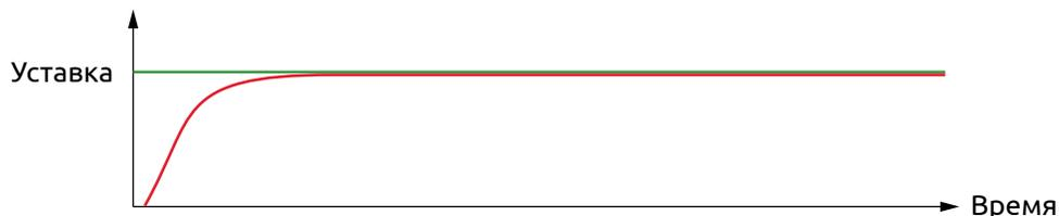
Рисунок 20 - Выход на уставку правильно настроенного ПИД-регулятора
