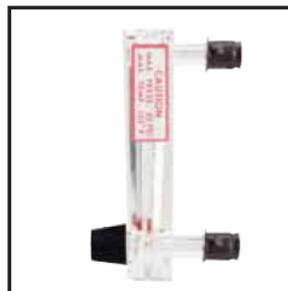
Модель MMF легко монтируется на передней панели. На панели сверлят два отверстия диаметром 9/32" и 5/16" с расстоянием между центрами 2-1/16". На задней стороне наденьте два пружинных держателя (поставляются) и установите резиновую или пластиковую трубку.
