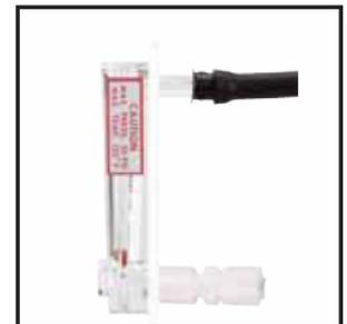
Присоединение модели MMF. Соединитель сверху, установленный в панель, имеет держатель и гибкую трубку. Соединитель снизу имеет альтернативное соединение с металлической или жесткой пластиковой трубкой и использует двойное компрессионное нейлоновое трубчатое соединение (как в A-328 компании Dwyer).
