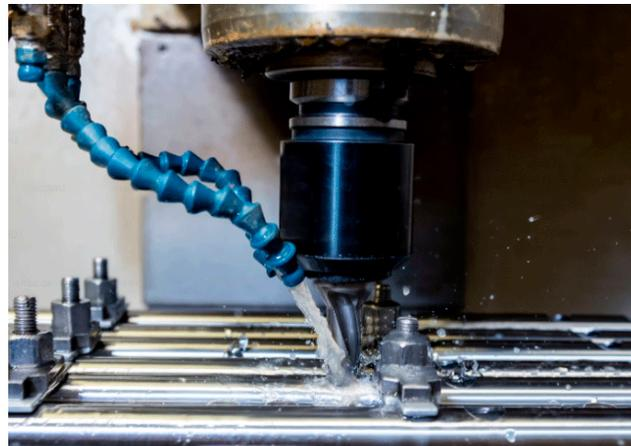
Станки предназначены для обработки металлов. Процесс обработки сопровождается сильным выделением тепла, от которого нагревается обрабатываемая поверхность и рабочий инструмент. Нагрев отрицательно влияет на качество обработки, повышается износ дорогостоящего инструмента и оснастки. Для снижения температуры в точке обработки применяются смазочно-охлаждающие жидкости. Также они способствуют удалению с рабочего пространства мелкой стружки и абразивной пыли, защищают детали от коррозии.
