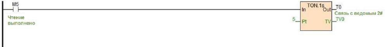
Время для определения отключения связи может быть установлено в соответствии с фактическим, как указано выше, когда M5 отключен более 5 секунд, катушка T0 будет выдавать сигнал тревоги об отключении связи.
