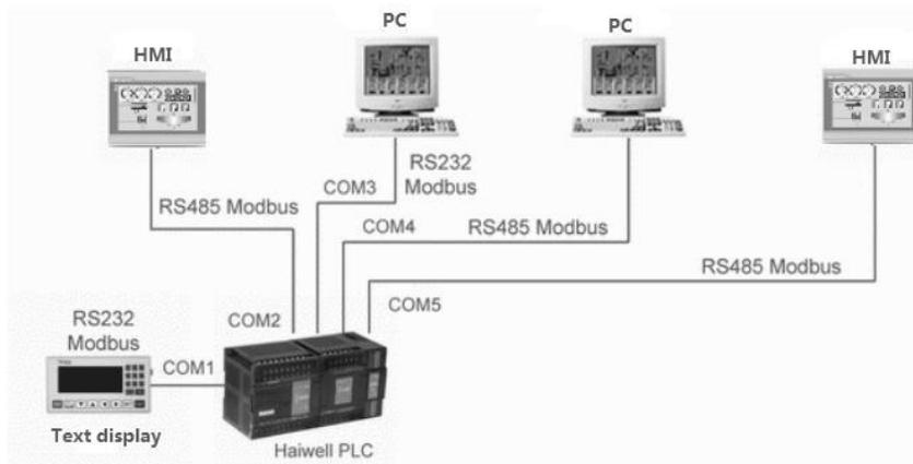
Когда ПЛК используется в качестве ведомого, нет необходимости писать программу, параметр по умолчанию — 19200 N 8 2 RTU, номер станции — 1. Для программного обеспечения конфигурирования и сенсорного экрана со встроенным драйвером Optimus Drive можно напрямую выбрать драйвер Optimus Drive, если нет драйвера Optimus Drive, можно выбрать драйвер Modbus от Modicon. Соответствующая таблица кодов связи Modbus показана на следующем рисунке:
