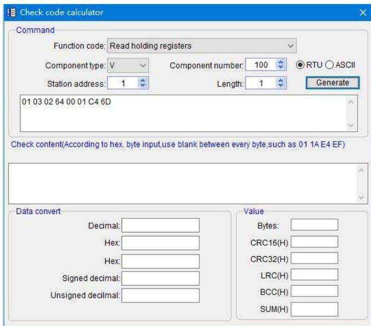
В поле окна выбираются функциональный код, тип компонентов, номер компонента, номер станции ведомого ПЛК и т.д., затем нажимаем «Создать (Generate)», получается команда: 01 03 02 64 00 01 C4 6D, отправленная компьютером верхнего уровня. позволяет прочесть значение V100 ПЛК.
