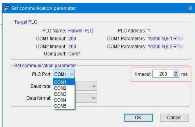
③ Инструменты последовательной отладки могут записывать интервал времени между отправкой данных и ответом. Поэтому перед обменом данными с ПЛК и оборудованием рекомендуется использовать инструменты отладки последовательного порта для связи с оборудованием, чтобы подтвердить номер станции оборудования, скорость передачи данных, формат данных и адреса Modbus для чтения и записи, время отклика и т.д. Это упрощает написание программы по связи с ПЛК. Например, на рисунке ниже 16 мс:
