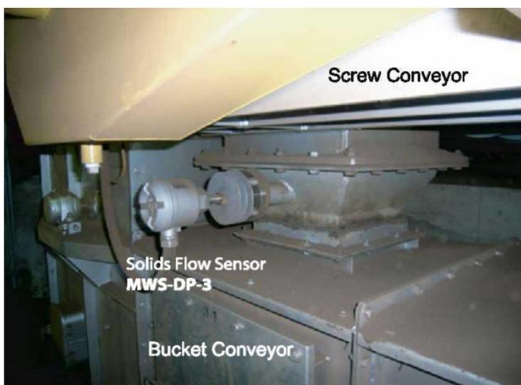
Это пример фактического применения датчика потока твердых частиц с функцией фильтра. Датчик устанавливается между двумя конвейерами. Расстояние между одним и другим конвейерами составляет 500 миллиметров.
