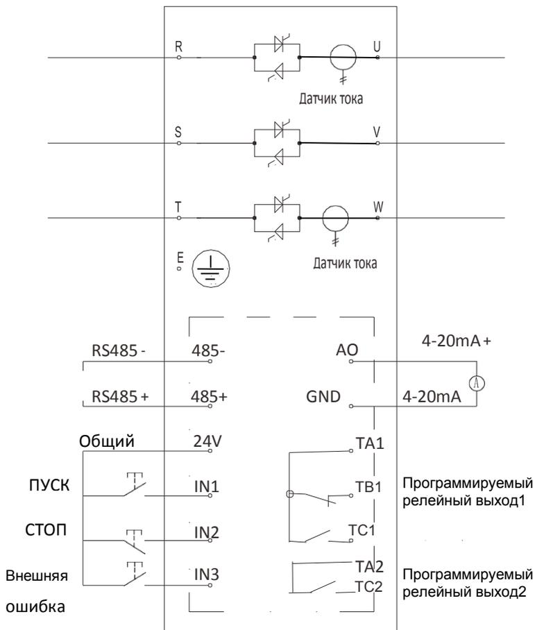
**Программируемое устройство плавного пуска AX100**
