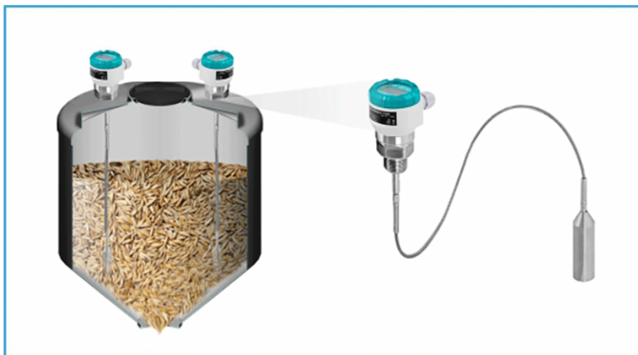
Измерение уровня и температуры крупы в емкости
