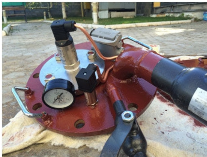
Рис. 2. Универсальная крышка (ТОО «Таразтехконтроль») с вибрационным сигнализатором уровня, датчиком давления и проч.
