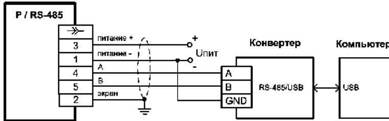
4-проводная линия (выходной сигнал – RS-485)
