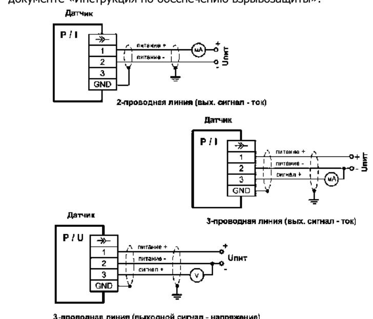
**Рисунок 1 – Примеры схем подключения выходов разъема DIN 43650A**
