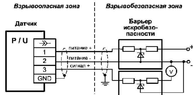
**Рисунок А.2 –** Пример схемы подключения аналогового выхода сигнала «напряжение» для разъема DIN 43650A
