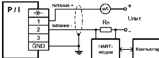
2-проводная линия (вых. сигнал – ток и HART)
