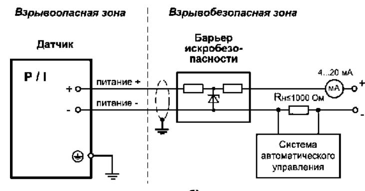
**Рисунок А.1 –** Примеры схем подключения аналоговых выходов сигнала «ток»: а) для разъема DIN 43650A; б) для кабельного ввода
