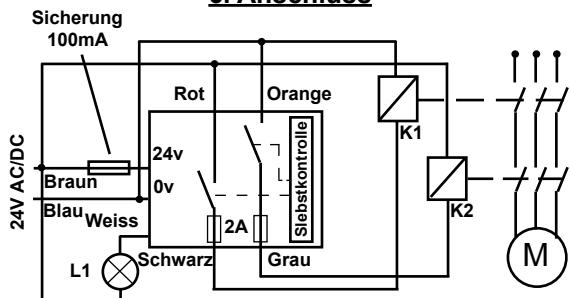
\* Um die Sicherheitskontakte zu schützen (innere 2A Sicherung), können Sie auch eine 1.6A auBere Sicherung nutzen.
