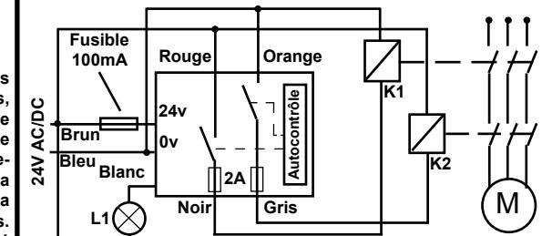
\*Toute surcharge ou court-circuit sur les lignes de sécurité provoque une ouverture de celles-ci de façon irrémédiable. Si vous estimatez qu'il existe un risque, nous vous conseillons de protéger les lignes avec un fusible de 1.6A rapide.
