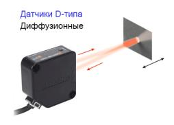
Для разных материалов будут разные нормированные расстояния срабатывания. Для грубой корректировки расстояний срабатывания в зависимости от материала объекта нужно использовать корректирующие коэффициенты, указанные в руководстве по эксплуатации датчика, например:
